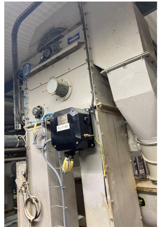
Kopfende eines Becherwerks mit neuem Gurtschleiflaufsensor, Lagertemperatursensor und Kabelverteilung. Es sind Anzeichen sichtbar, dass die Walze oder der Gurt geschleuert und Spuren am Gehäuse hinterlassen hat.
