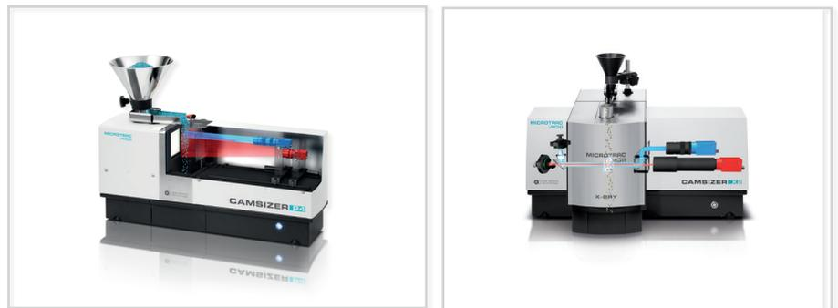
Abb. 1: Zwei moderne DIA Partikelanalysatoren - CAMSIZER P4 (links) und CAMSIZER X2 (rechts) von Microtrac MRB. Das P4 Modell eignet sich für die schnelle Analyse rieselfähiger Schüttgüter in einem Größenbereich von 20  $\mu\text{m}$  bis 30 mm, das X2 Modell ist optimiert für feine, pulverförmige Probenmaterialien in einem Größenbereich von 0,8  $\mu\text{m}$  bis 8 mm.
